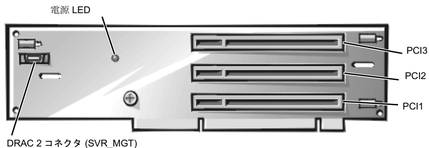
図 8-2 ライザボード 拡張カードコネクタ
